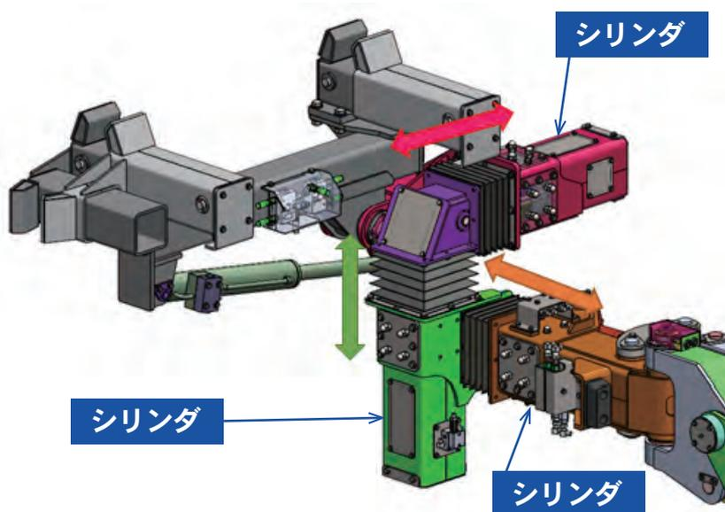
キャッチ部に3軸方向の微調整機構を持たせ、支保工建込時の位置決めを容易に行うことができます。微調整機構は、それぞれ±115mmのストロークがあります。
