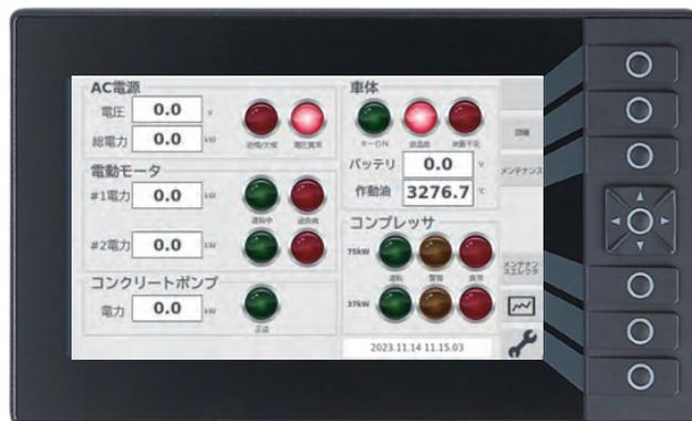
メインモニタは制御盤に搭載しており、遠隔地からの操作が可能です。（要 Wifi 接続）
