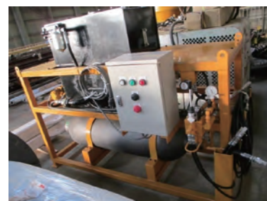
緊急退避用蓄圧式ユニット
